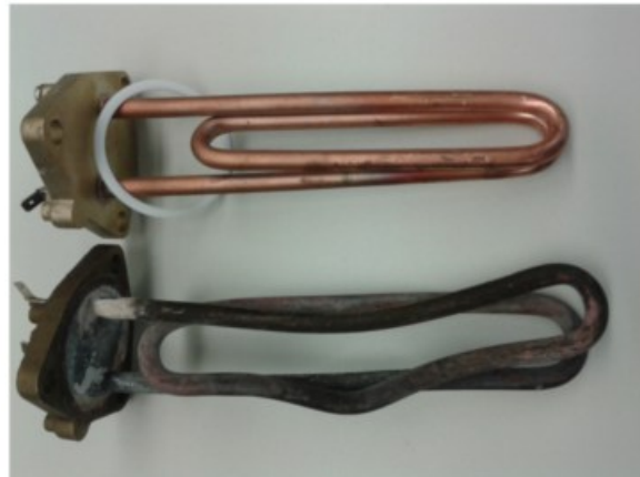
Abbildung 5: Auswahl defekter Teile Oben links: Defekte Füllstandsanzeige. Oben rechts: Sand und Ablagerungen im Kessel. Unten: Defekte und neue Heizspule
