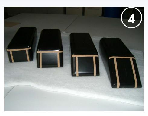
Die notwendigen Arbeitsschritte zur Modellerstellung unterteilen sich in Fräsen der Modellrohkörper (1), Behandlung mit Spritzspachtel und folgendes Nass-Schleifen (2), Aufbringung von 2-Komponenten-Lack (3) und Anbringung von Sandpapierstreifen zum Erzwingen einer turbulenten Strömungsablösung im Windkanal (4).
