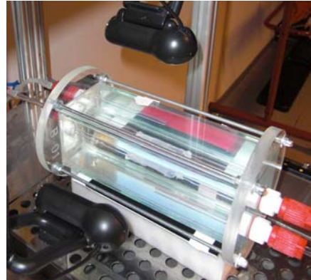
Bild 1 und 2: Techn. Zeichnung und bestückte Berstkammer im Versuch
